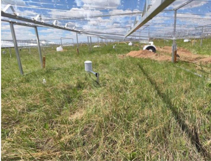
空气温湿度传感器是一种装有湿敏和热敏元件，能够用来测量温度和湿度的传感器装置，现场和数据采集器配合使用，通过分析温湿度数据，研究人员可以更好地了解样地环境，对研究提供可靠的数据支持。
